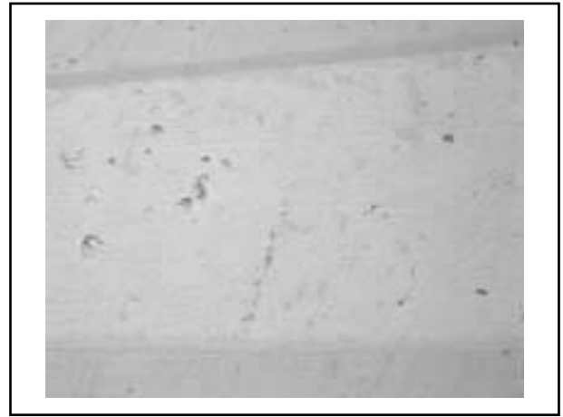
図 31. Sn/Ag/Cu/Sb半田、温度サイクル1000回
