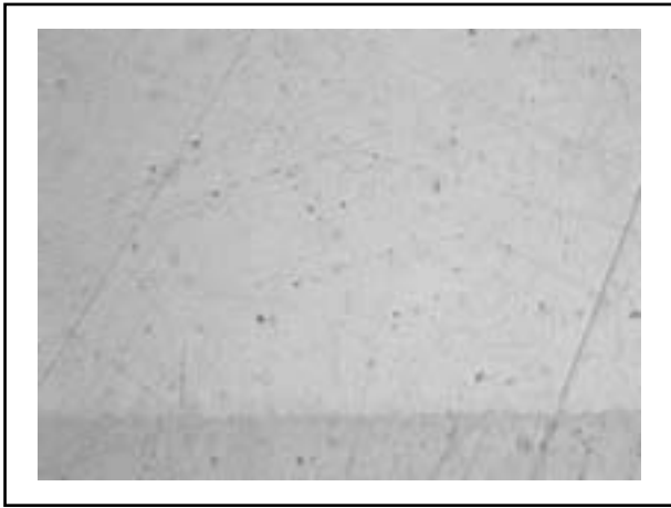
図 30. Sn/Ag/Cu/Sb半田、温度サイクル0回
