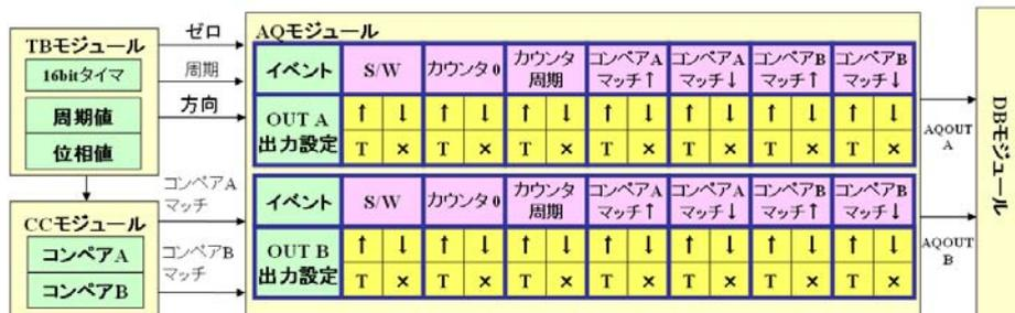
図 69:AQ モジュールでの基本波形生成設定
