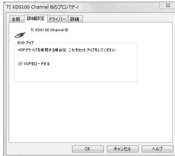
上図のように、プロパティ・ウィンドウが表示されますので、詳細設定タブのセットアップ欄の”VCPをロードする”にチェックをいれてOKを押してください。次に、controlSTICKをPCから抜いて、再度挿してください。
