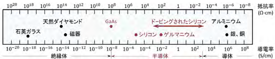
図 1.2.1 物質の抵抗率 \rho と導電率 \sigma ( \sigma=1/\rho )
