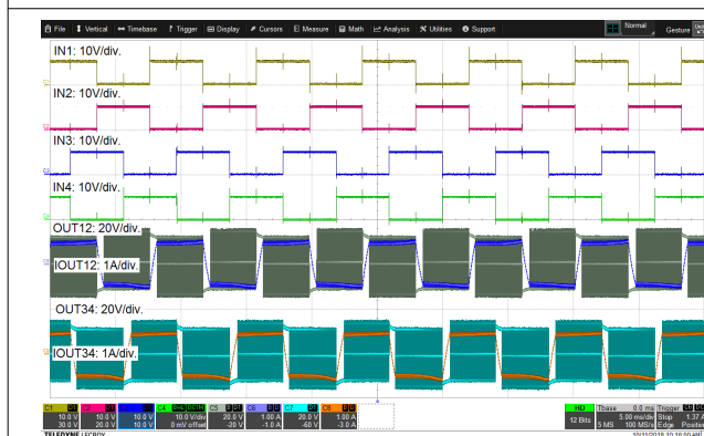
図 8-7. ステッピング・モータのフル・ステッピング動作
