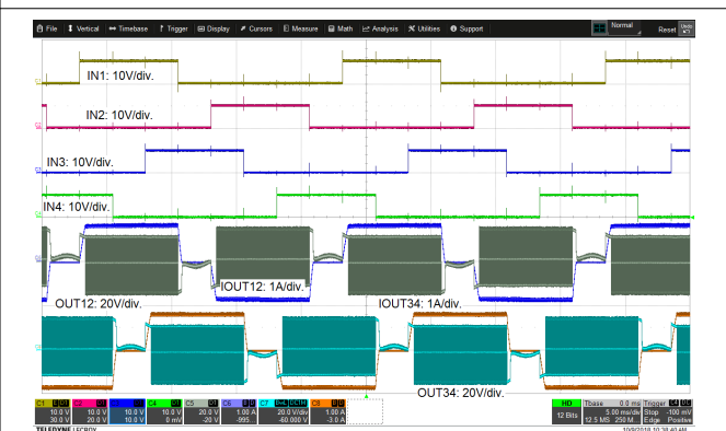
図 8-8. ステッピング モータのハーフ ステッピング動作、オフ状態時 Hi-Z
