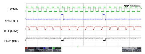
Figure 24. SYNIN (2.2 MHz) VIN 4.2 V
