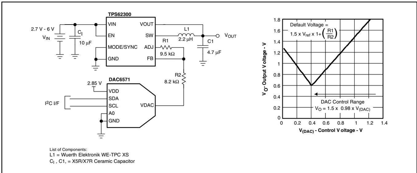
図39. I<sup>2</sup> CI/Fによる動的電圧管理
