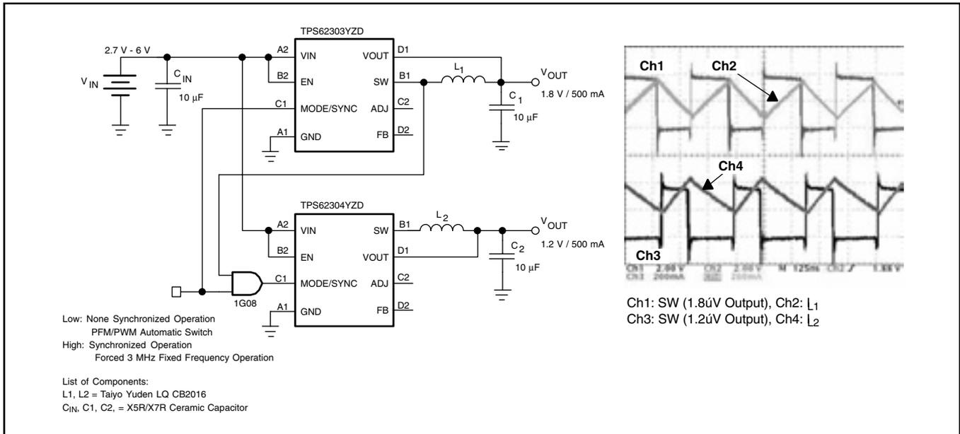
図37. デュアル、逆相、3MHz、500mA降圧型レギュレータ：ソリューションの合計サイズは50mm<sup>2</sup>未満
