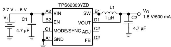
図1. 最小ソリューション・サイズのアプリケーション (固定出力電圧)
