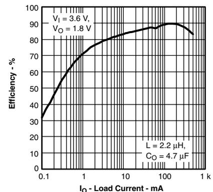
図2. 効率vs負荷電流
