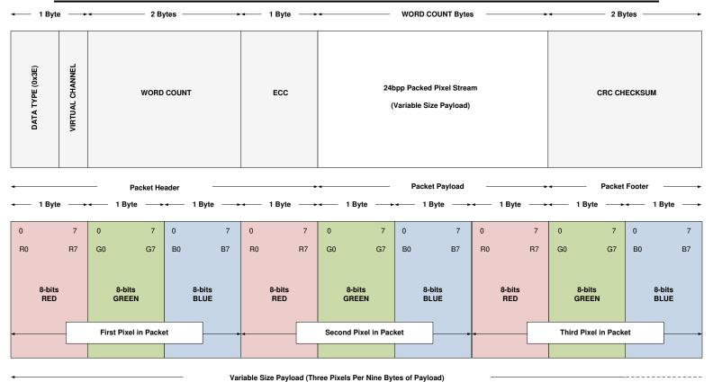
図 8-9. 24bpp DSI Packet Structure
