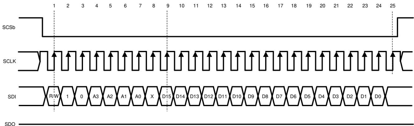
**图 7-4. Serial Data Protocol - Write Operation**
