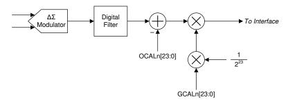
図 8-14. Calibration Block Diagram
