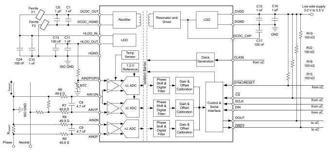
図 9-8. Power Supply Decoupling the AMC131M03
