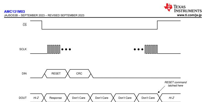
図 8-26. RESET Command Frame
