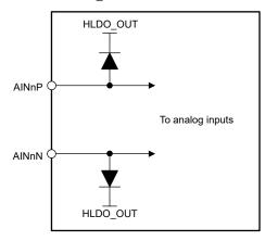
図 8-3. Input ESD Protection Circuitry
