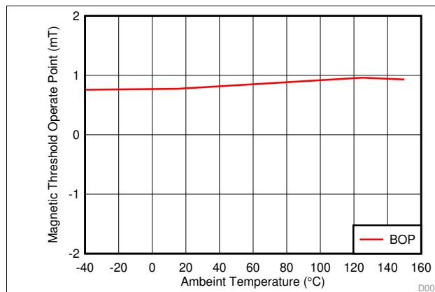
図 1.  $B_{OP}$  Threshold vs Temperature (DRV5015A1-Q1)
