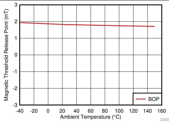
図 6.  $B_{OP}$  Threshold vs Temperature (DRV5015A2-Q1, DRV5015A3-Q1)
