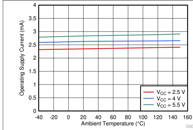
図 5.  $I_{CC}$  vs Temperature (DRV5015A1-Q1)
