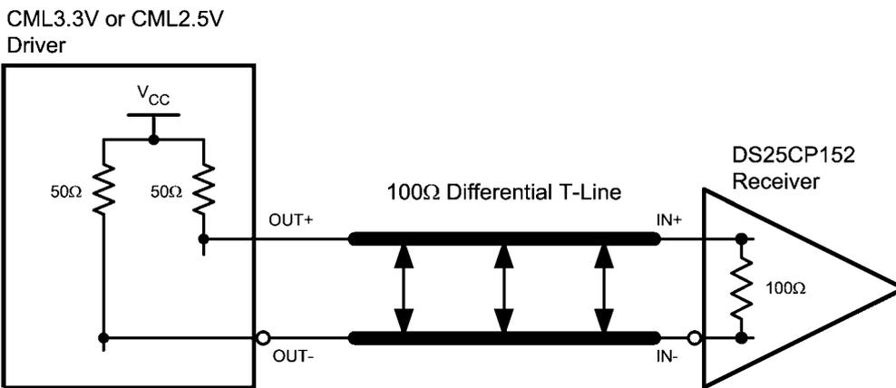
Typical CML Driver DC-Coupled Interface to DS25CP152 Input
