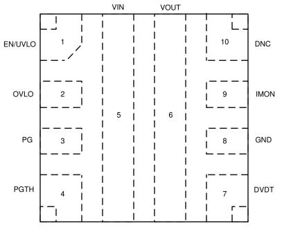
図 5-1. LM73100 RPW Package 10-Pin QFN Top View
