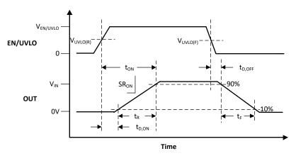
図 6-1. LM73100 Switching Times
