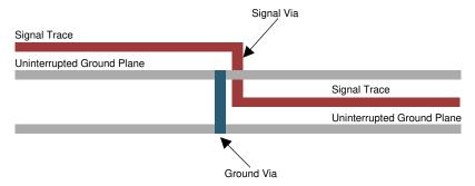
図 30. Ground Via Location (Side View)
