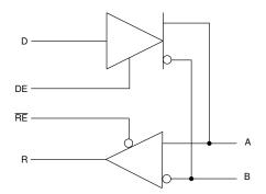
図 14. SN65MLVD206B Block Diagram
