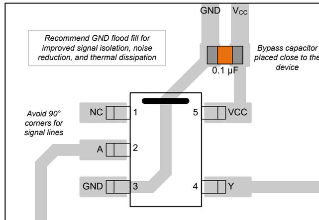
図 8-3. レイアウト例 : SN74LV1T34-Q1
