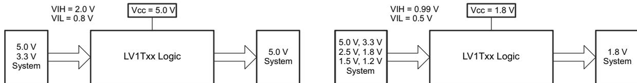
図 7-3. LVxT の昇圧および降圧変換の例
