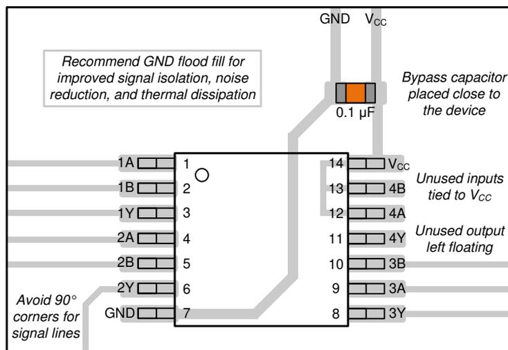
図 10-1. レイアウト例：SN74LV4T08-EP
