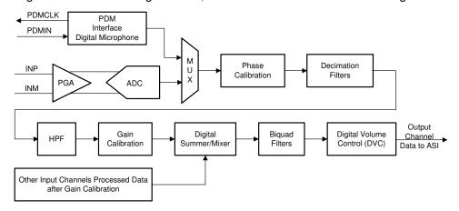
図 8-16. Signal-Chain Processing Flowchart
