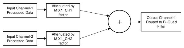
図 8-18. Programmable Digital Mixer Block Diagram
