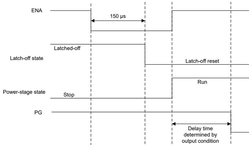
**Figure 7-6. Latch-Off Reset Using ENA Pin**
