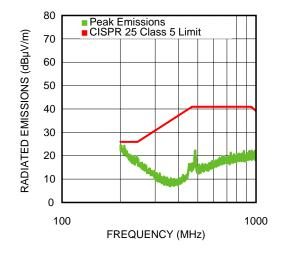
Figure 20. 200 MHz-1000 MHz Horizontal1A Load
