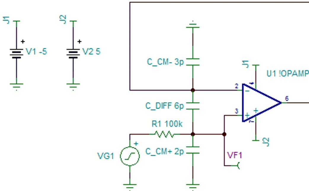
Figure 4. TINA-TI Software Schematic  $C_{CM+}$
