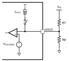
図 6-12. UVLO Pin Resistor Divider
