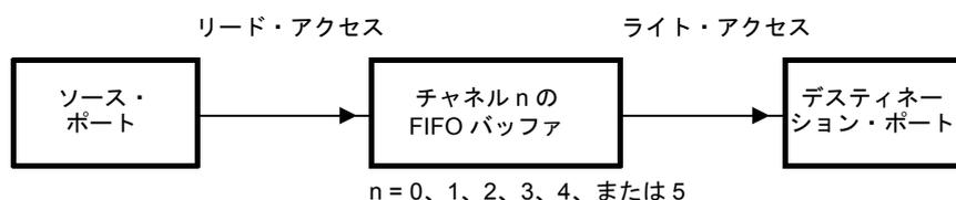
チャンネルで転送が発生する条件セットは、**チャンネル・コンテキスト**と呼ばれます。6つのチャンネルにはそれぞれチャンネル・コンテキストをプログラミングおよび更新するためのレジスタ構造が含まれています（図3.を参照）。コンフィギュレーション・レジスタは、コードによって変更します。データ転送を行う際は、コンフィギュレーション・レジスタの内容が作業レジスタにコピーされ、DMA コントローラが作業レジスタの値を使用してチャンネルの動作を制御します。コンフィギュレーション・レジスタから作業レジスタへのコピーは、コードでチャンネルが有効にされる（DMACCR で EN=1）たびに行われます。また、自動初期化モードがオン（DMACCR で AUTOINIT = 1）の場合も、そのコピーがブロック転送間で行われます。自動初期化モードの詳細については、16 ページの 3 節「チャンネルの自動初期化機能」を参照してください。DMA コントローラのレジスタの詳細については、39 ページを参照してください。
