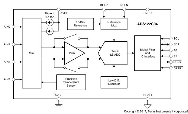
図 2. ADS122C04 Block Diagram
