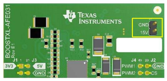
図 11. BOOSTXL-AFE031 Power Pins
