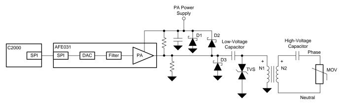
**図 19. Recommended Transient Protection**
