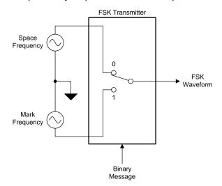
図 7. Transmitter Example
