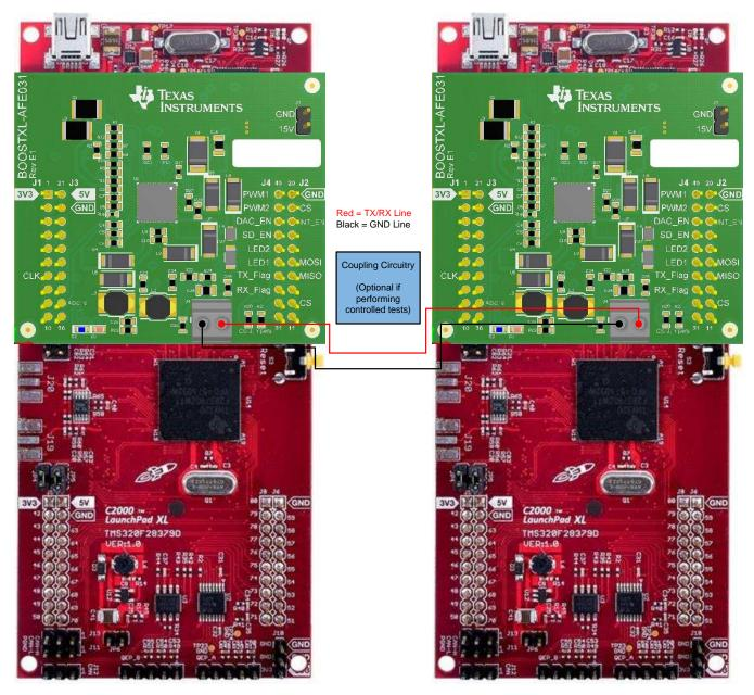
図 15. TX-RX Solution System
