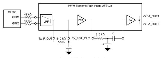
図 29. PWM Transmit Path
