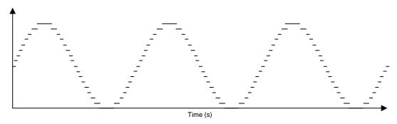
図 35. DAC Sine Wave Ramp
