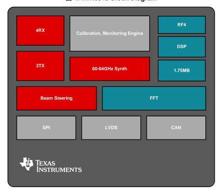
図 4. IWR6843 Block Diagram
