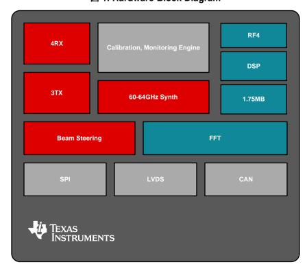
図 1. Hardware Block Diagram
