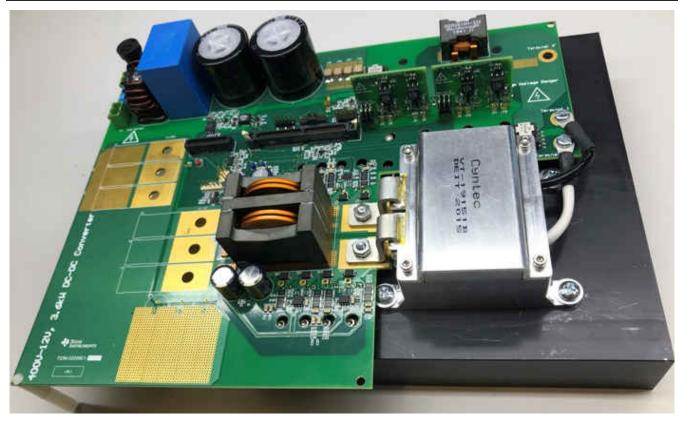
図 3-27. DC-DC Converter Module
