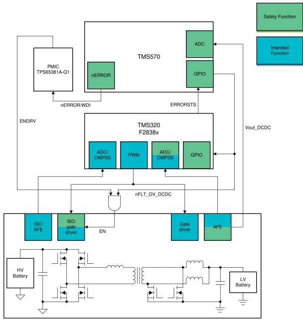
図 3-26. DC-DC System Block Diagram
