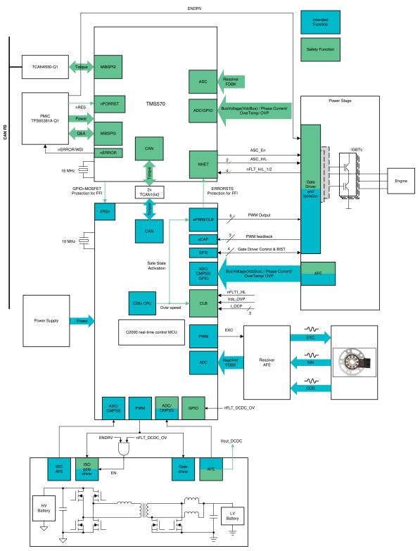
図 2-1. TIDM-02009 Block Diagram
