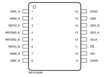
Figure 4-1. Pin Diagram
