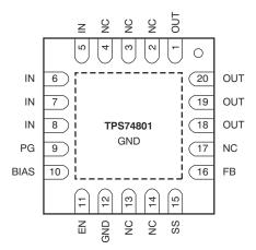
Figure 4-1. Pin Diagram (VQFN) Package
