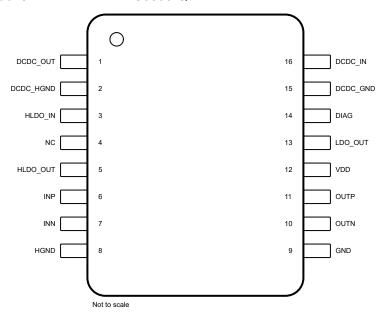
Figure 4-1. Pin Diagram
