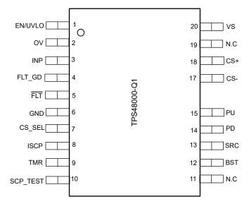
Figure 4-1. Pin Diagram
