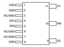
Figure 4-1. TPSI2072-Q1 Pin Diagram
