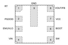
Figure 4-1. Pin Diagram
