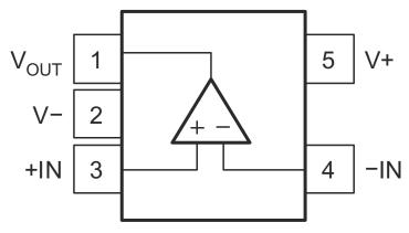
Figure 4-1. Pin Diagram (SOT-23) Package
