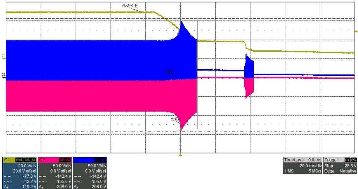
Figure 3-9. Soft-Stop Disabled No Load Primary MOSFETs
