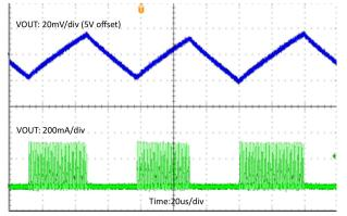
Figure 4-6. TPS61099 Vin 3.6 V, Vout 5 V, Iout 25 mA
