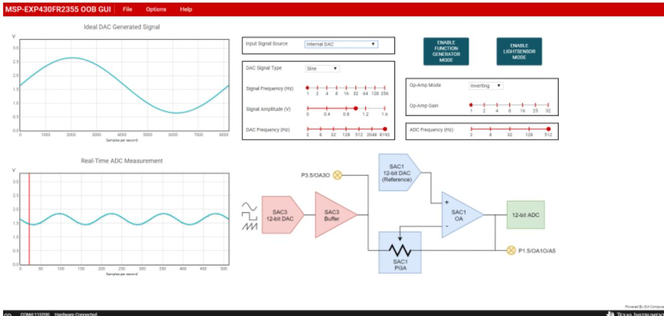
**Figure 3. Smart Analog Combo GUI**
