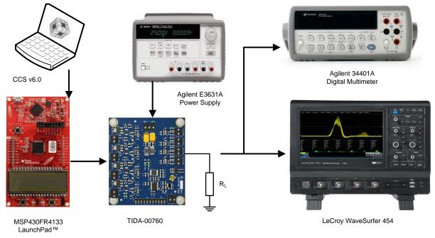
Figure 24. TIDA-00760 Test Setup
