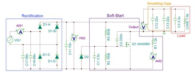
Figure 3. Soft-Start Schematic
