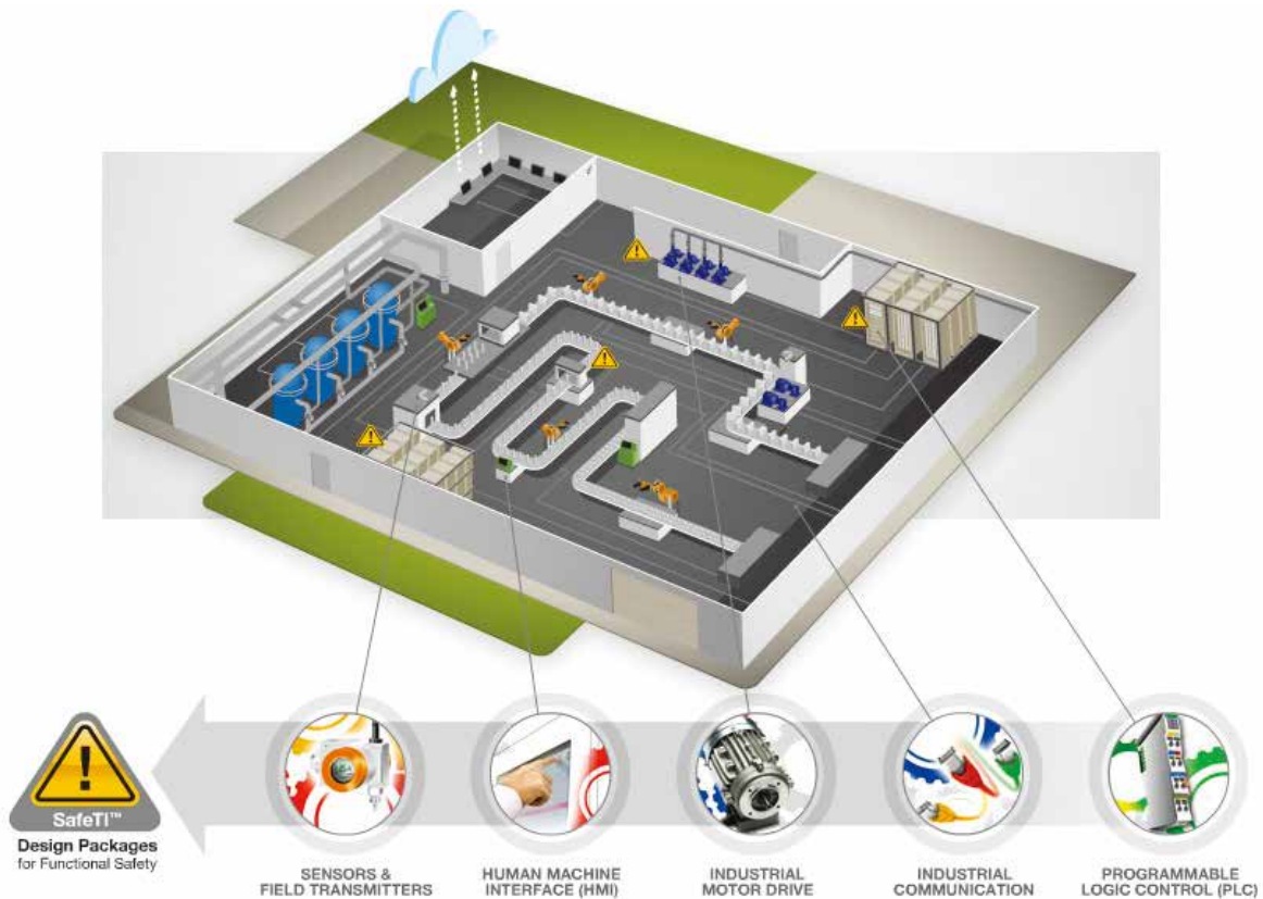
図 1：産業用オートメーション・コンポーネントおよび通信リンク
