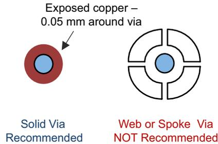
図 3-1. 最下層の銅プレーンのビア接続
