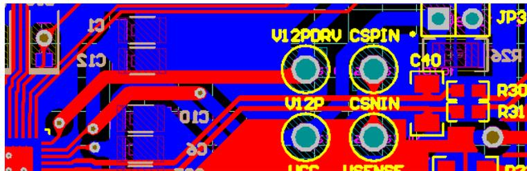
図 7-8. 入力および出力フィルタのレイアウト
