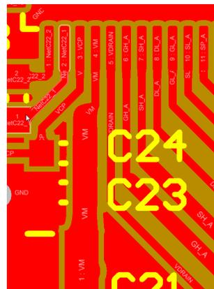
図 6-13. VDRAIN のケルビン接続
