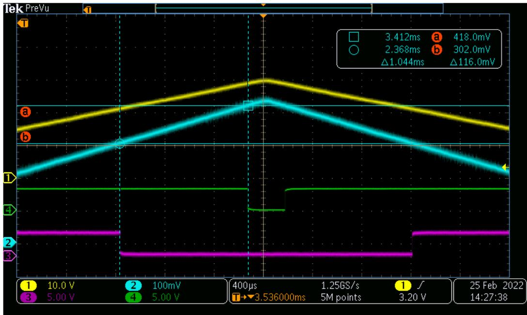
$V_{supp}$  が増加するときの IN の波形
