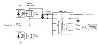
図 1. AMC1301 の機能ブロック図
