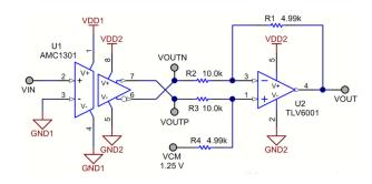
図 5. 差動からシングルエンドへのスケーリングされた出力
