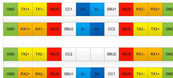
図 2. USB-C ピン配置: レセプタクル (上)、プラグ (下)
