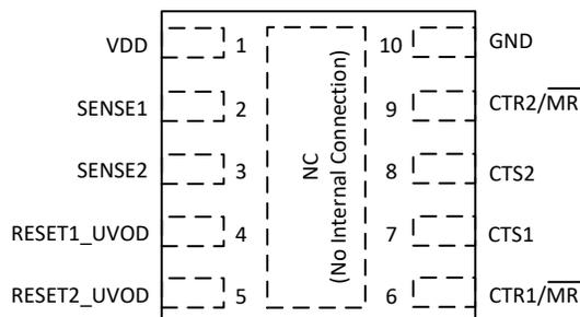
**Figure 4-1. Pin Diagram DSK Package 10-Pin WSON**
