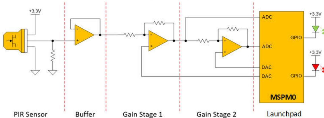
**Figure 1-6. Capacitor Free Signal-Chain**
