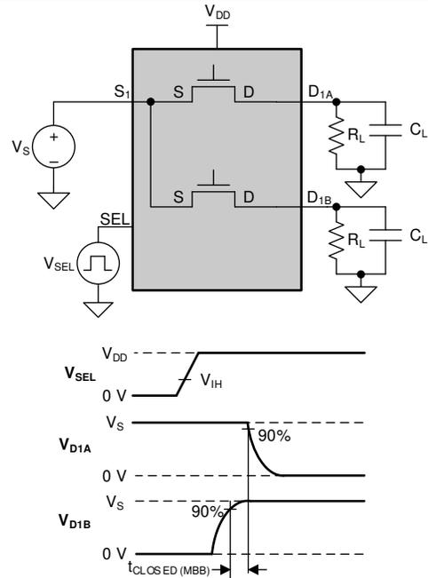
**Figure 7-4. Make-Before-Break Time**
