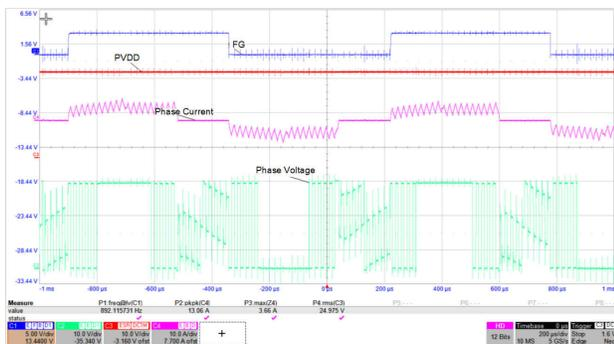
**Figure 4. Mixed PWM Modulation**
