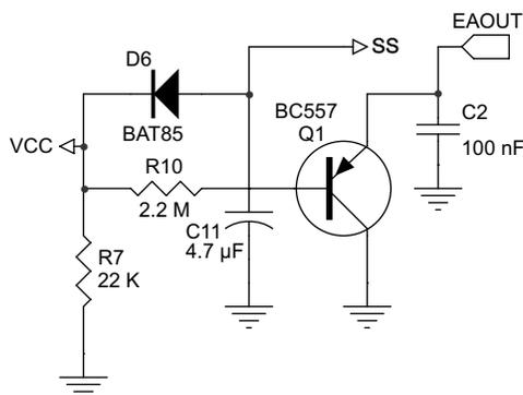
Figure 7. Soft-Start Circuit
