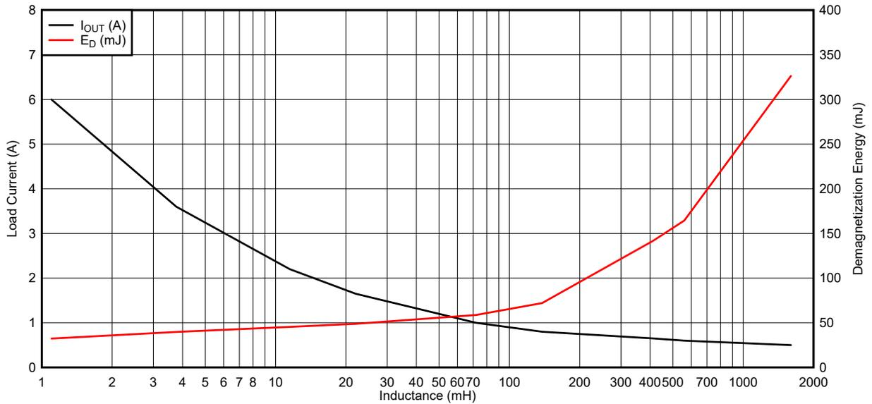
**Figure 6-20. TPS4H160-Q1 Demagnetization Energy Capability**
