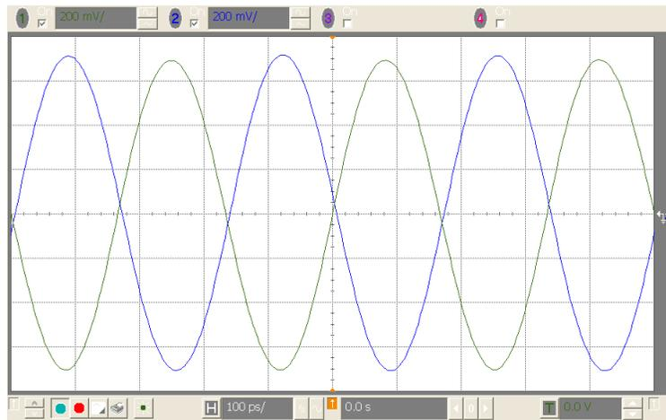
**Figure 3-8. Before Phase Synchronization**
