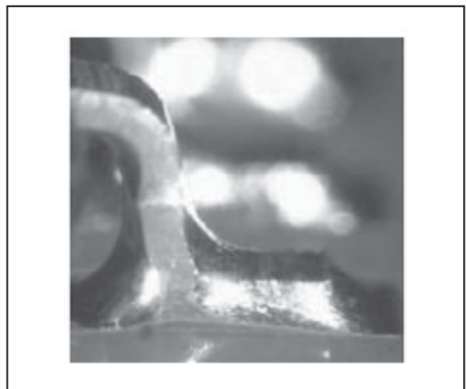
図12. SnPbメッキNSパッケージ、SnPbAg半田、OSPコーティングPWB
