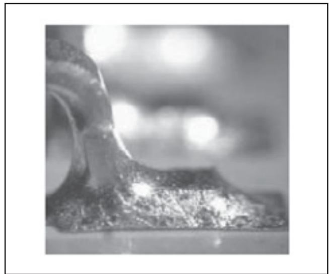
図10. SnPbメッキNSパッケージ、SnPbAg半田、NiAuメッキPWB
