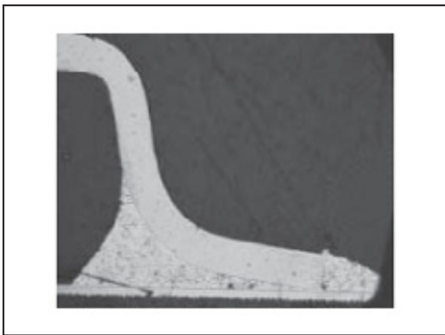
図37. NiPdAuメッキSOPパッケージ、SnAgCu半田(温度サイクル1000回後)
