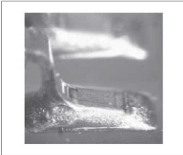
図15. NiPdAuメッキNSパッケージ、SnAgCu半田、OSPコーティングPWB
